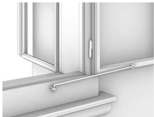
Abb.21: Im 3D-Modell dargestellter Windhaken zur Sicherung nach außen öffnender Fenster.
