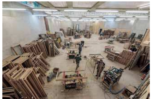
Abb.20: Blick in die Feldwerkstätte der Fenstertischler während der Restaurierung der rund 720 bauzeitlichen Fenster des Österreichischen Parlamentsgebäudes in Wien.
