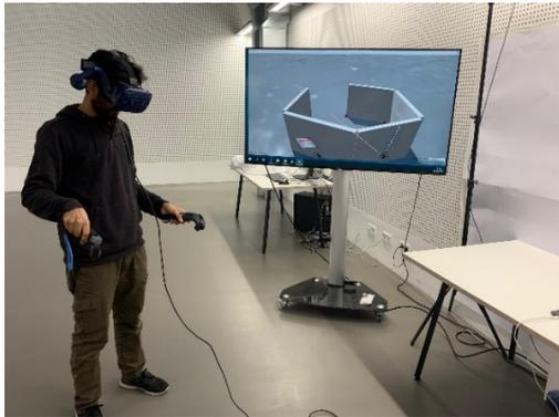
Abbildung 4: Definition der Raumgeometrie im Modelling-Mode innerhalb der prototypisch implementierten VR-Simulationsumgebung
