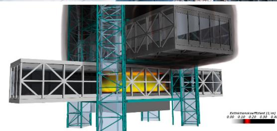
Abbildung 8: Brandsimulation eines Nutzungseinheit in einer Turmstruktur auf Basis eines BIM-Modells
