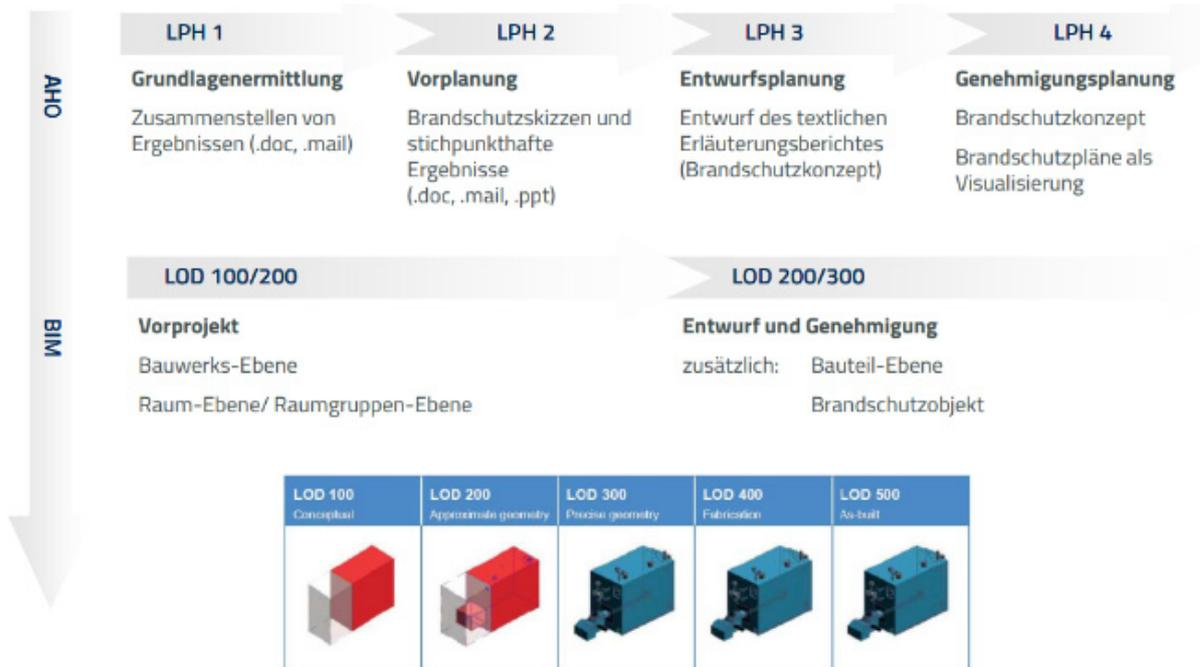
Abbildung 2: Detaillierungsgrad der Brandschutz-Informationen des BIM-Modells in Abhängigkeit der Leistungsphase (Plum und Teske, 2020).
