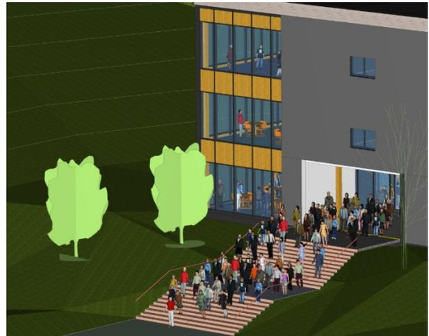
Abbildung 10: Beispiel einer Evakuierungssimulation auf Basis eines BIM-Modells
