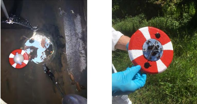
Abbildung 13: Sewer-Ball Versuche im Kanal mit Schwimmhilfe.
