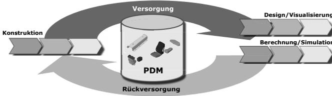
Abb. 4.22: Rolle des PDM in der Fahrzeugentwicklung
