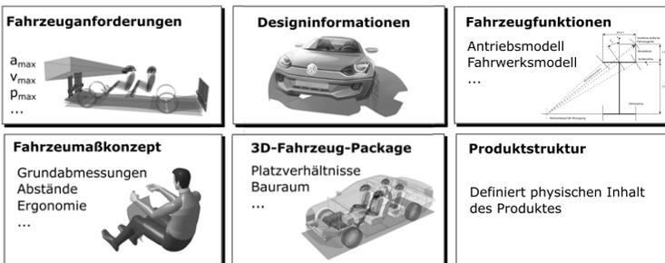
Abb. 3.2: Wesentliche Bestandteile eines virtuellen Fahrzeugkonzeptes
