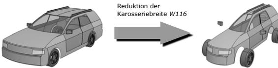
Abb. 5.59: Mögliche Degeneration von CAD-Modellen infolge Parameterkonstellationen
