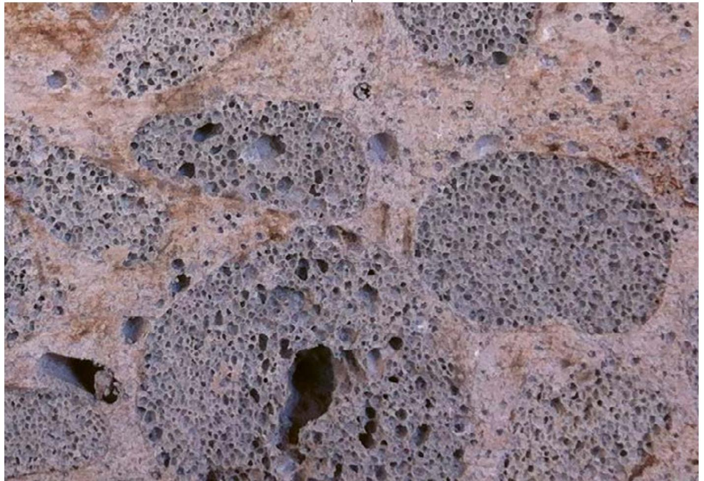
Abb. 46: Gefügedichter Leichtbeton von Technopor mit einem Lambda von  $0,22 \text{ W/m}^2\text{K}$  und Glasschaumschotter als Gesteinskörnung
