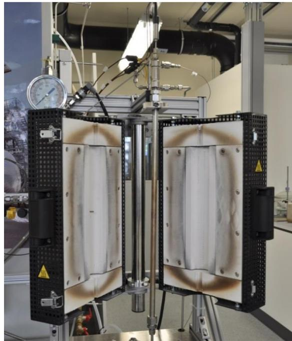
Abb. 1: Rohrreaktor mit Heizmantel
