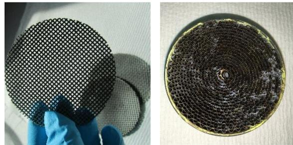
Abb. 2: Zwei Katalysatoren auf metallischen Trägermaterialien. Ein Katalysator auf Gitterträgern (links), sowie auf gewickeltem Trägermaterial mit Wellenstruktur (rechts)
