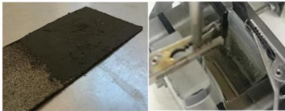
Abb. 3: Eine Lufterlektrode nach Pressen/Sintern (links), welche dann in die Halbzelle eingebaut wird (rechts)
