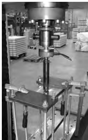
(a) Halterung für Holzbauschraube mit d = 4 mm
