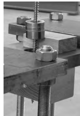
(c) Probekörper mit durchgeschraubter Holzbauschraube
