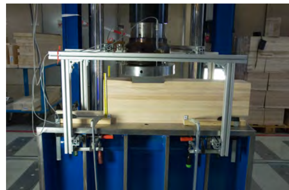
(e) Deformierte Schwelle mit beidseitigem Vorholz unter Lasteinleitungsplatte und Kugelkalotte
