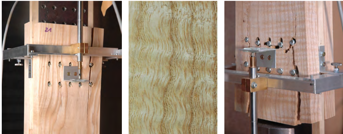
(a) Risse längs zur Faser im Bruchzustand (b) Gewellter Faserverlauf bei sogenanntem Engelshaar (ES_T8_00_10.5) (c) Risse quer und längs zur Faser im Bruchzustand (Probekörper ES_T8_00_10.5)
