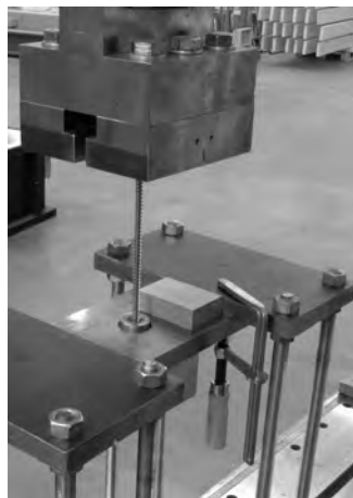
(b) Schraubhalterung mit Zentrier링 für Holzbauschraube mit d \geq 6 mm
