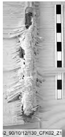
(b) Probekörpern der Serie „zurückgesetzter Verbund“ mit zähmodifiziertem Klebstoff nach Pörtner und Seim (2008)
