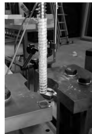
(c) Nach Prüfung mit Einschraubwinkel 90^\circ
