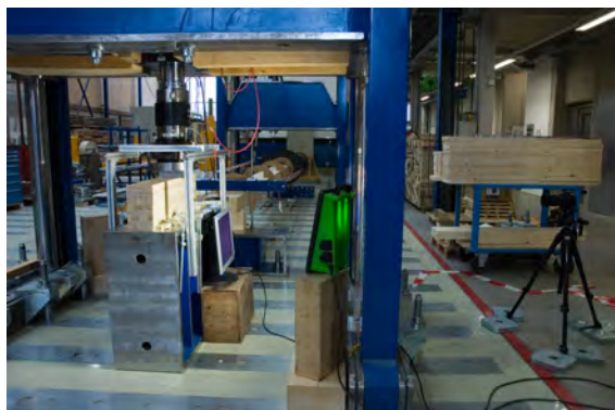
(d) Auflagerbock, Aluprofile für die Wegaufnehmer, Monitor und südseitige Kamera
