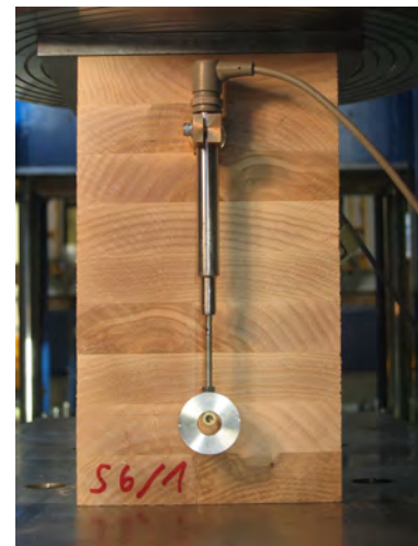
(c) Quaderförmiger Probekörper aus Eschen-Seitenware ES_S6_1
