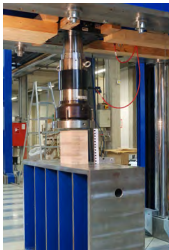
(a) Prüfgerüst mit seitlich gehaltenem Prüfzylinder und quaderförmigen Probekörper
